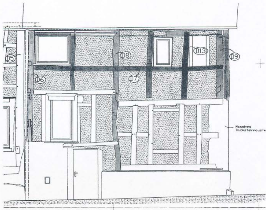
Baualtersplan 1: Nordfassade des ursprünglichen Wohnhauses.
